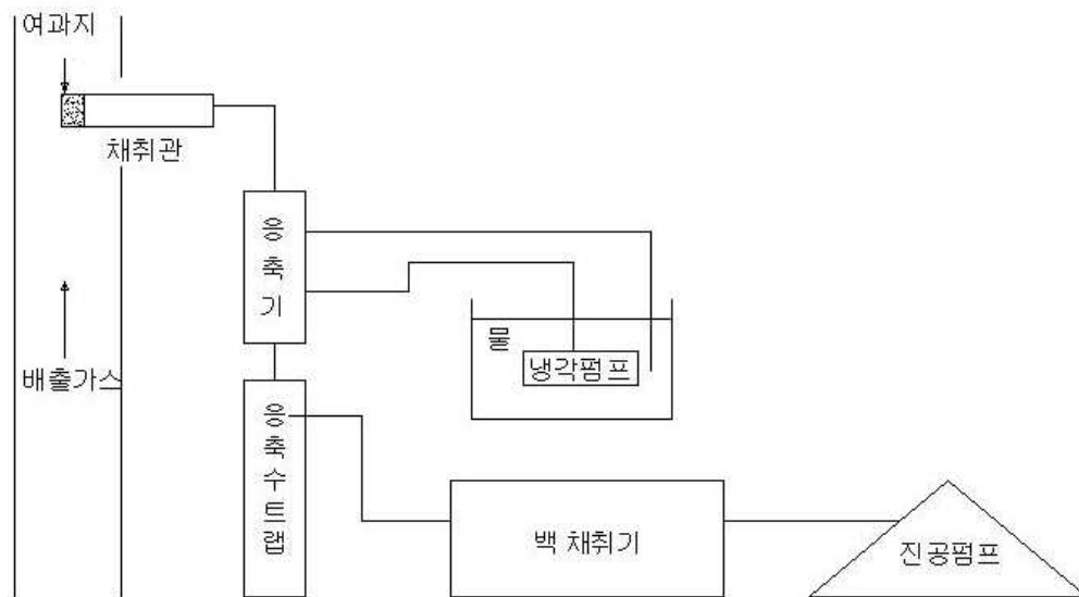
그림 28. 시료채취장치 (Tedlar bag)
